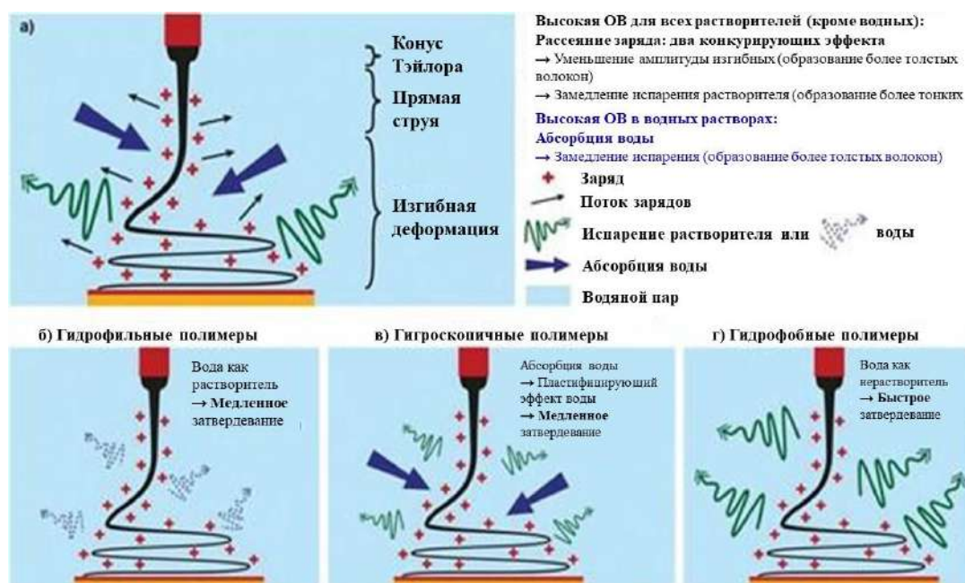
Рисунок 5 – а) Влияние влажности при высокой относительной влажности (ОВ) на скорость испарения струи при электроформовании в зависимости от растворителя. Влияние влажности при высокой относительной влажности (ОВ) на скорость затвердевания струи при электроформовании в зависимости от гидрофильности полимера: б) гидрофильный, в) гигроскопичный и г) гидрофобный [55]
