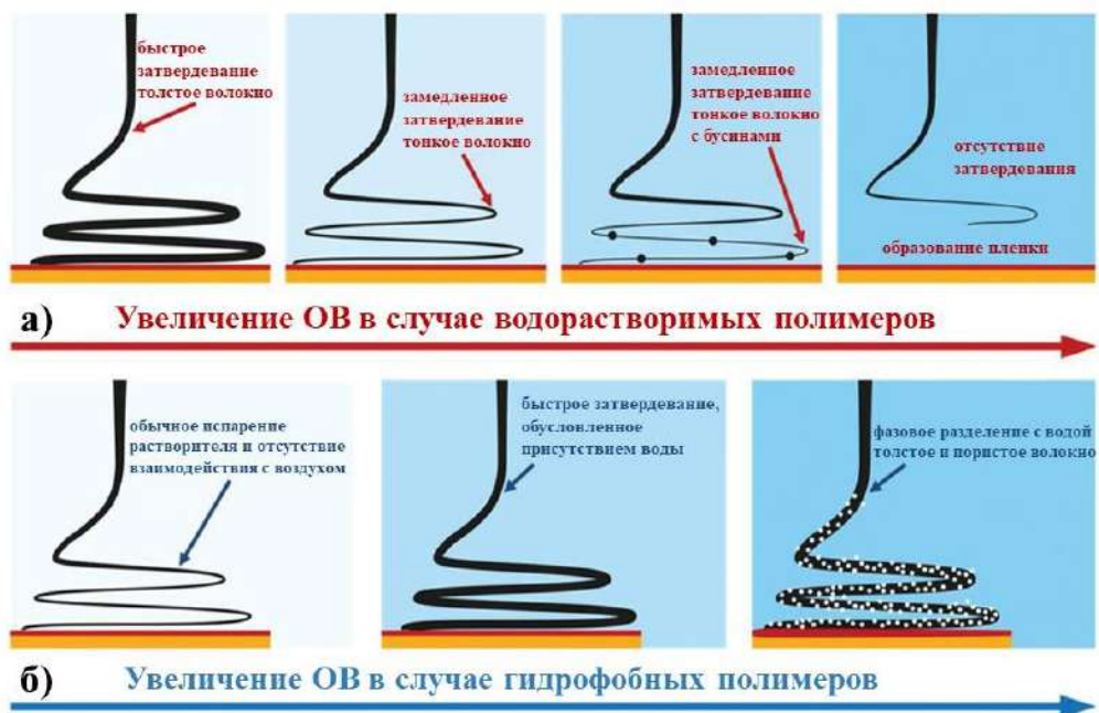
Рисунок 6 – Схематическое изображение влияния относительной влажности на диаметр волокна. а) Случай гидрофобных полимеров. б) Случай водорастворимых полимеров в водных системах растворителей и гигроскопичных полимеров, которые при высокой относительной влажности могут пластифицироваться молекулами воды [55]
