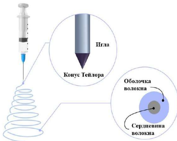
Рисунок 11 – Схематическое изображение процесса формирования волокон методом коаксиального электроформования [29]
